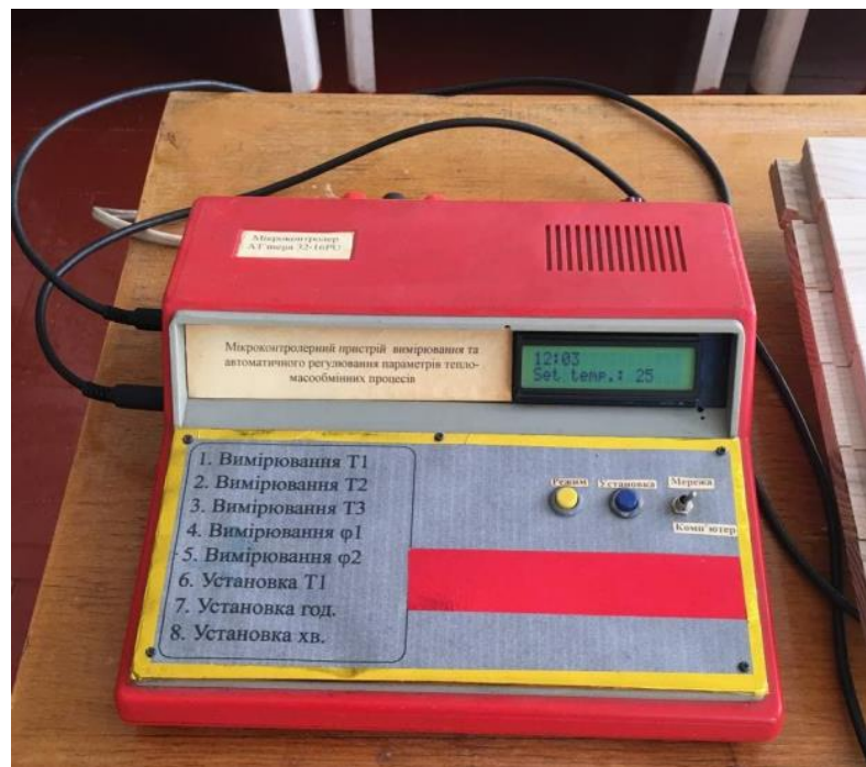
Рис. 3.5 – Вимірювальний прилад для контролю температури і вологості
