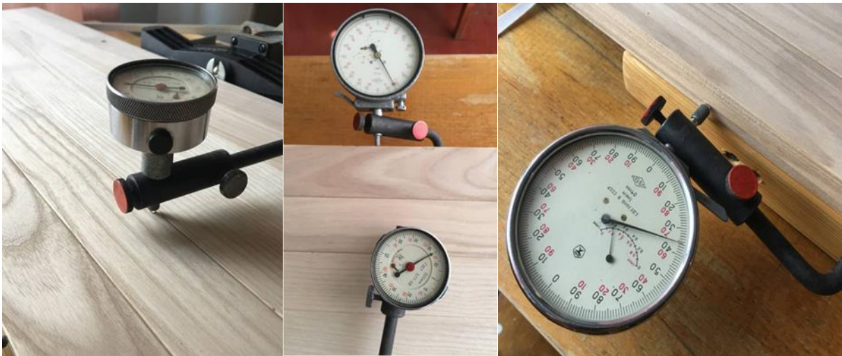
Рис. 3.7 – Вимірювання деформацій паркетних планок
