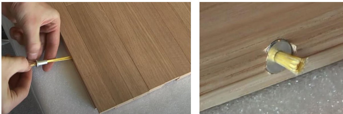
Рис. 2.8 – Кріплення шнура заглушками
