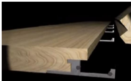
Рис. 2.6 – Використання металевих скоб для кріплення паркетних планок
