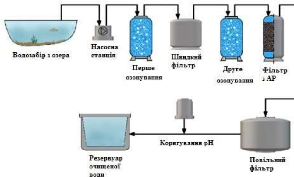
Рис. 3.4 – Схема підготовки питної води з Цюріхського озера
