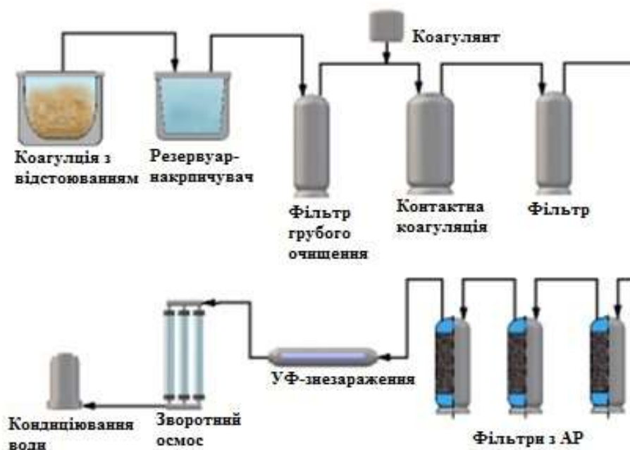
Рис. 3.5 – Схема підготовки питної води з поверхневого джерела в Великобританії
