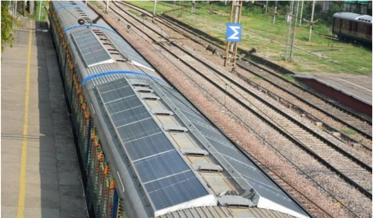
Рисунок 5.1 – Встановлені сонячні панелі на даху локомотива
