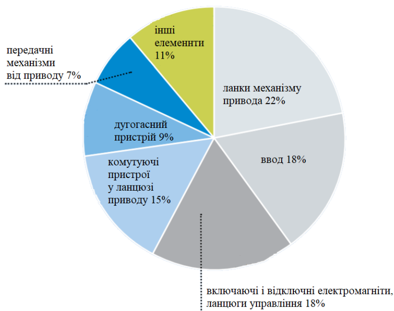
Рисунок 1.7 - Відмови оливних бакових вимикачів
