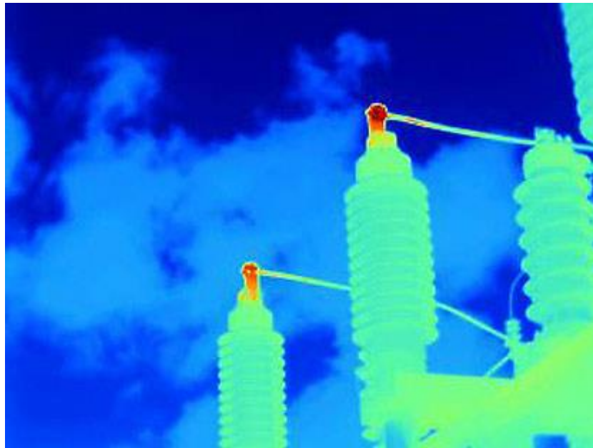
Рисунок 2.1 – Тепловізійний контроль трансформаторів струму.
