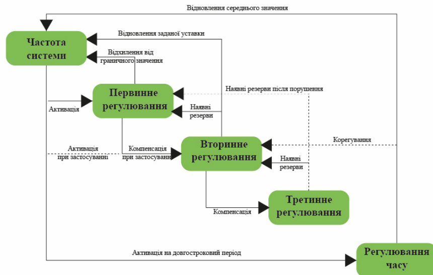
Рисунок 1.9 – Функціональна схема системи регулювання частоти та потужності в енергосистемі [4]
