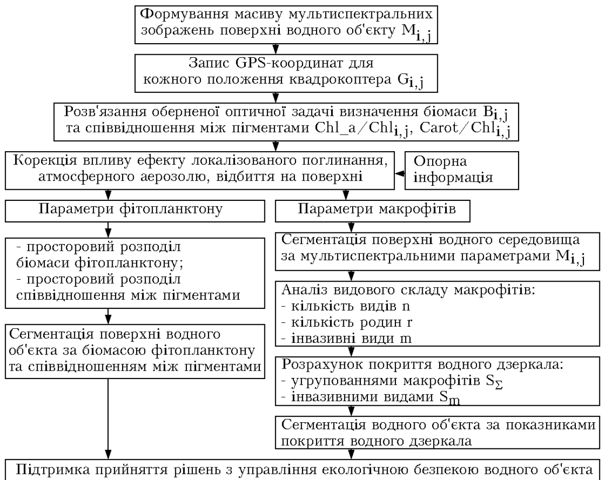
Рисунок 3.5 – Структурна схема оцінювання екологічного стану водних об'єктів з використанням біоіндикації за допомогою мультиспектрального методу та квадрокоптера
