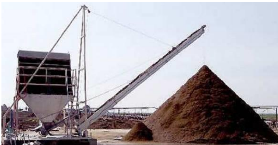
Рисунок 5.13 - Обладнання для механічного зневоднення річкових відкладень
