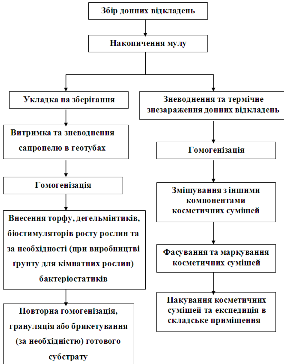
Рисунок 5.12 - Інноваційна технологічна схема переробки річкового мулу
