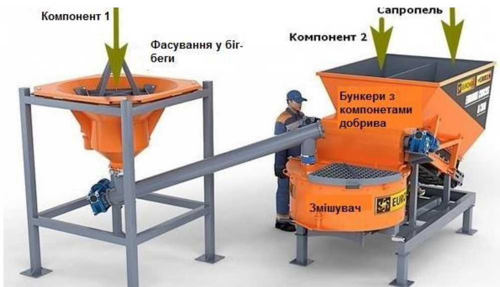
Рисунок 5.14 - Технологічна схема виробництва сапропельно-органічного добрива за допомогою мобільного змішувача ГСУ В-1800.
