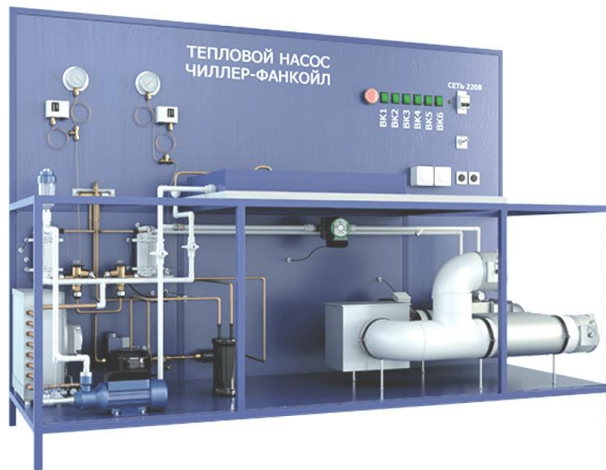
Рисунок 1.1 – Експериментальний стенд для дослідження характеристик теплового насосу «повітря-вода» з повітряно-водяним теплообмінником для відбирання теплоти
