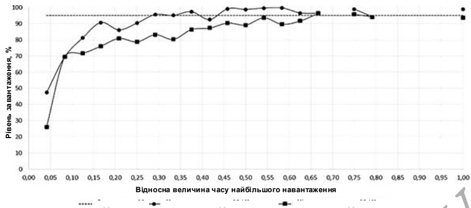
Рисунок 4.8 - Діапазони зміни значень рівнів завантаження мережевих з'єднань в ЧНН залежно від відносної тривалості часу найбільшого навантаження для максимальних рівнів завантаження в діапазоні 95% - 100%
