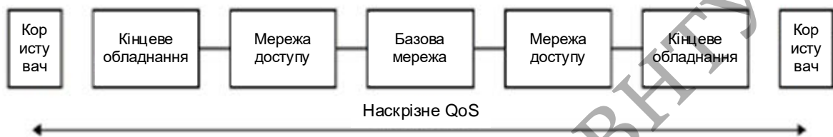
Рисунок 1.2 - Схематичне представлення компонентів наскрізного QoS
