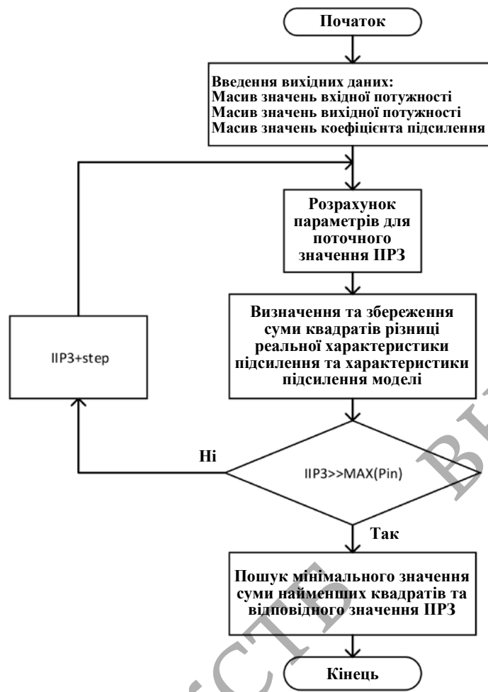
Рисунок 4.4 - Блок-схема алгоритму розрахунку апроксимованої підсилювальної характеристики
