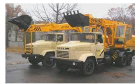
Рисунок 3 - Екскаватори-планувальники АТЕК-011А і АТЕК-012А на базі шасі КраЗ-65101
