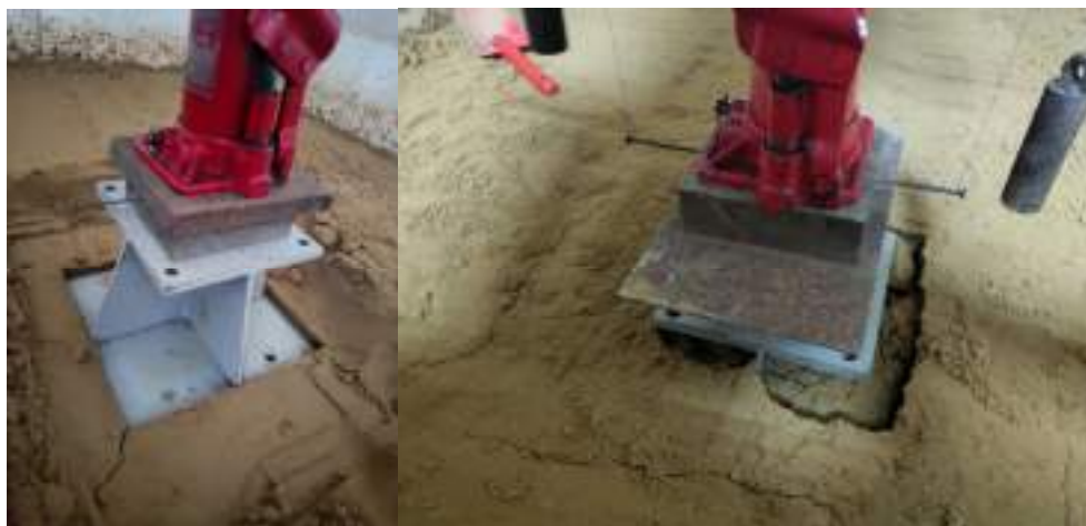
Рисунок 2.11 – Стан основи при втраті ґрунтом стійкості при глибинах закладання фундаменту 0, 1 та 0,5 b
