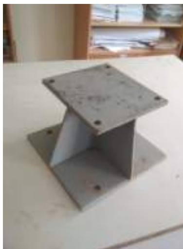
Рисунок 2.3 – Модель фундаменту мілко́го закладання з розмірами подошви 230×245 мм
