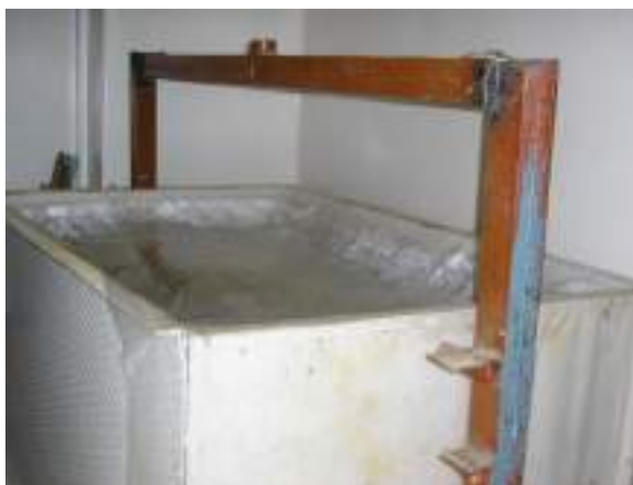
Рисунок 2.1 – Лоток з ущільненим піском, накритий поліетиленовою плівкою для збереження вологості
