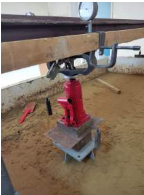
Рисунок 2.9 – Система навантаження моделі фундаменту у ґрунті при глибині закладання 0,5 b
