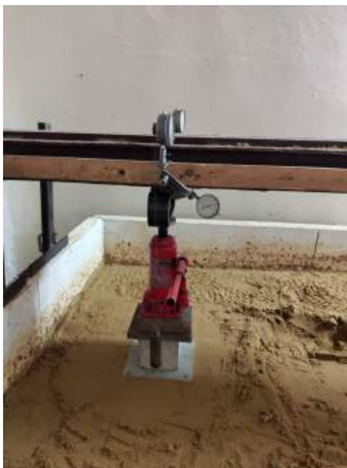
Рисунок 2.5 – Модель стовпчастого фундаменту перед випробуванням
