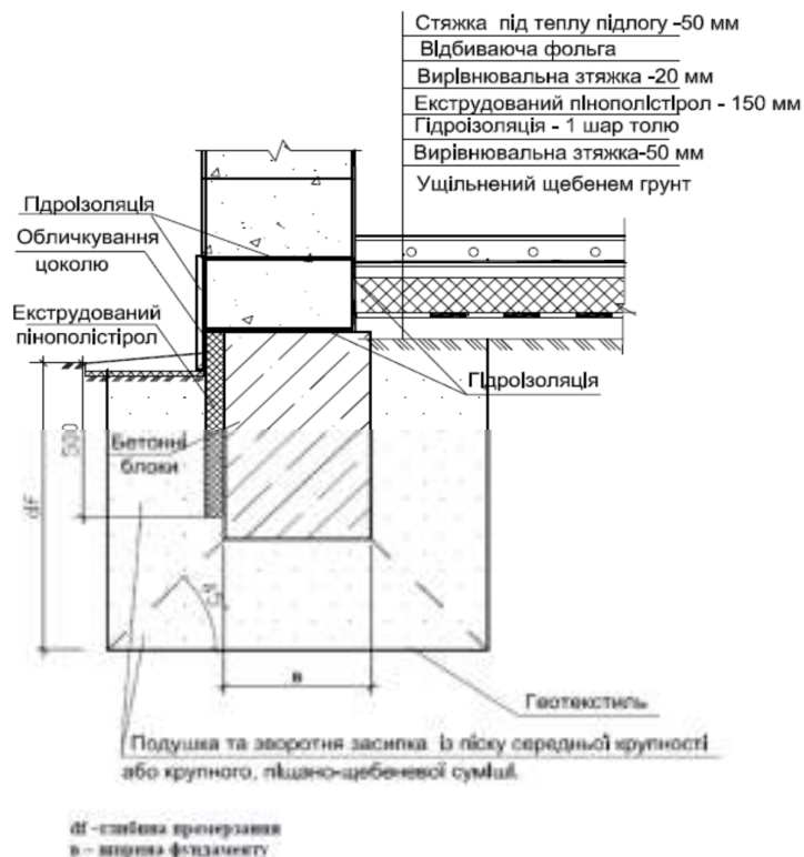
Рисунок 1.3 – Фундамент мілкого закладання на протиздимальній подушці [8]
