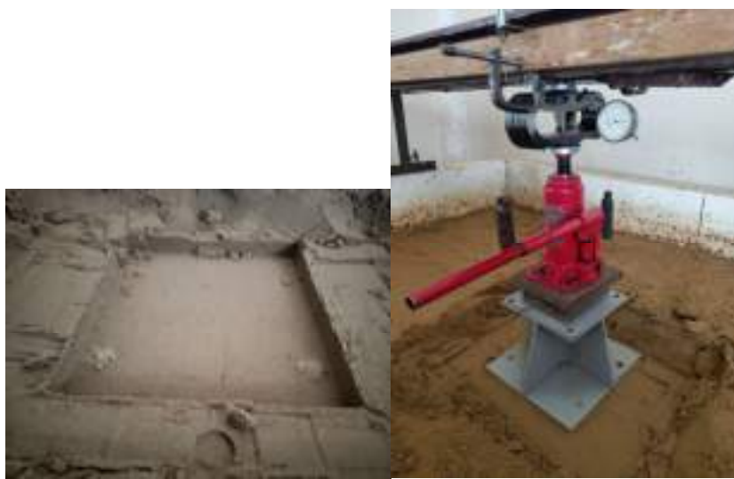
Рисунок 2.7 – Підготовка котловану і розміщення моделі фундаменту у ґрунті при глибині закладання 0,1 b
