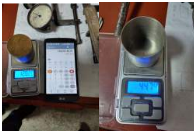
Рисунок 2.2 – Контроль щільності укладання піску в лоток
