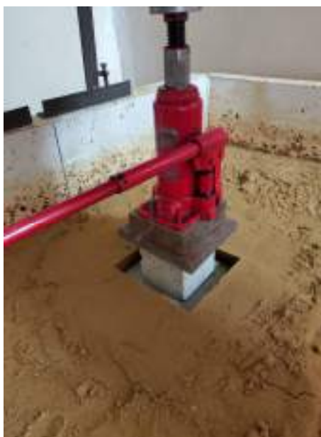
Рисунок 2.12 – Характер деформацій основи після втрати ґрунтом стійкості при глибині закладання 1,0b
