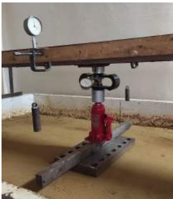
Рисунок 2.6 – Модель стрічкового фундаменту перед випробуванням
