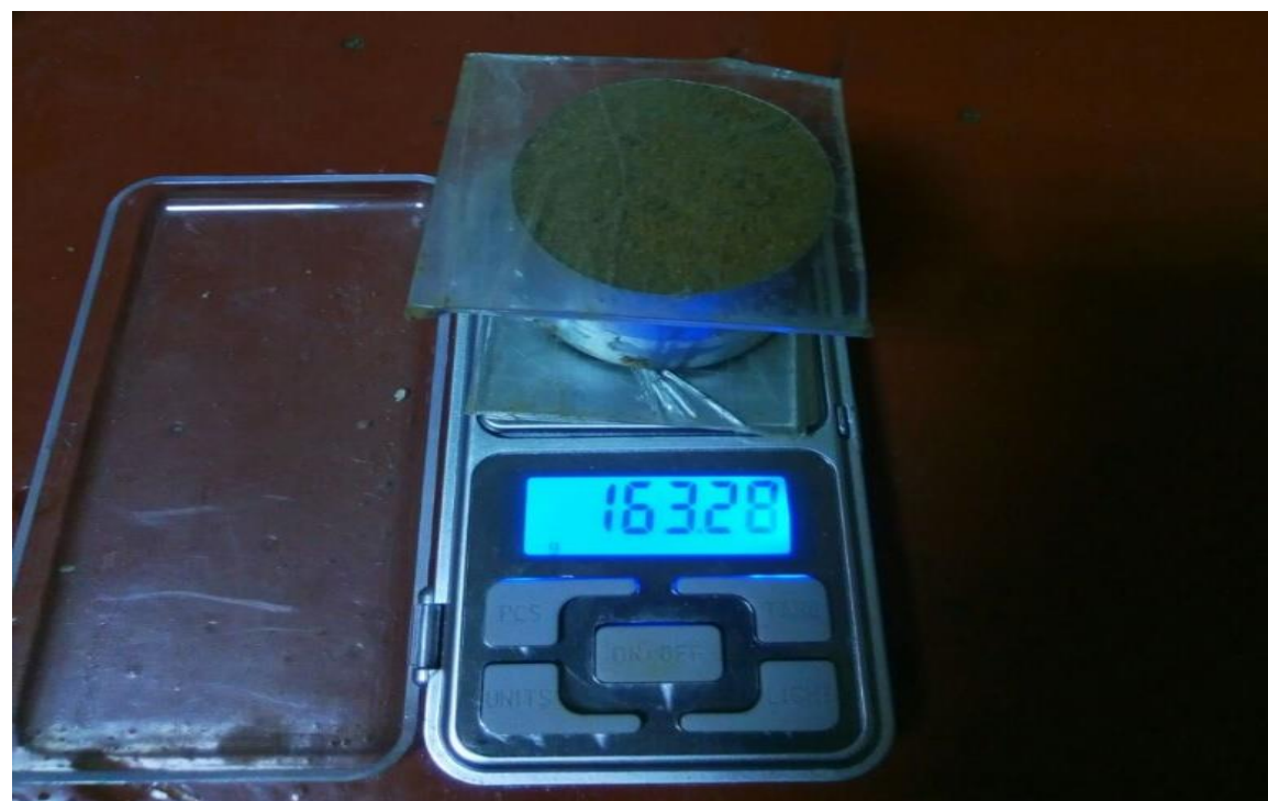
Вага ущільненого ґрунту з кільцем та скельцями
