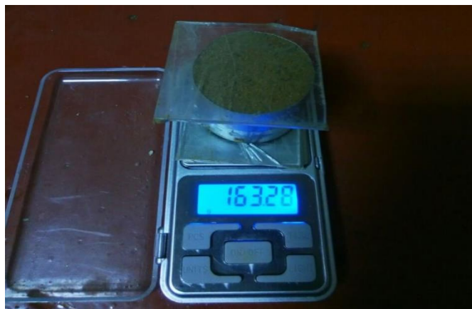
Рисунок 2.2 – Вага ущільненого ґрунту та кільця
