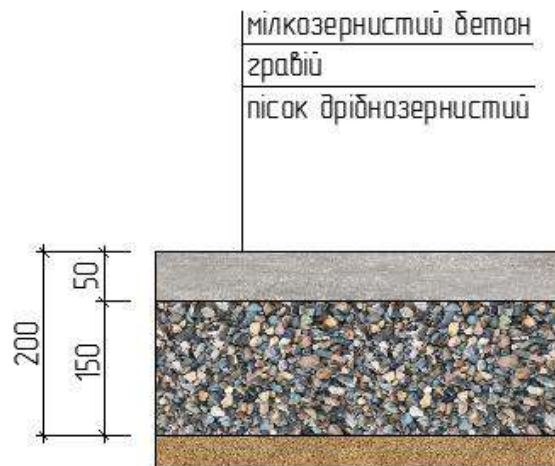
На рисунку 4.16 – Конструкції дорожнього покриття тротуару
