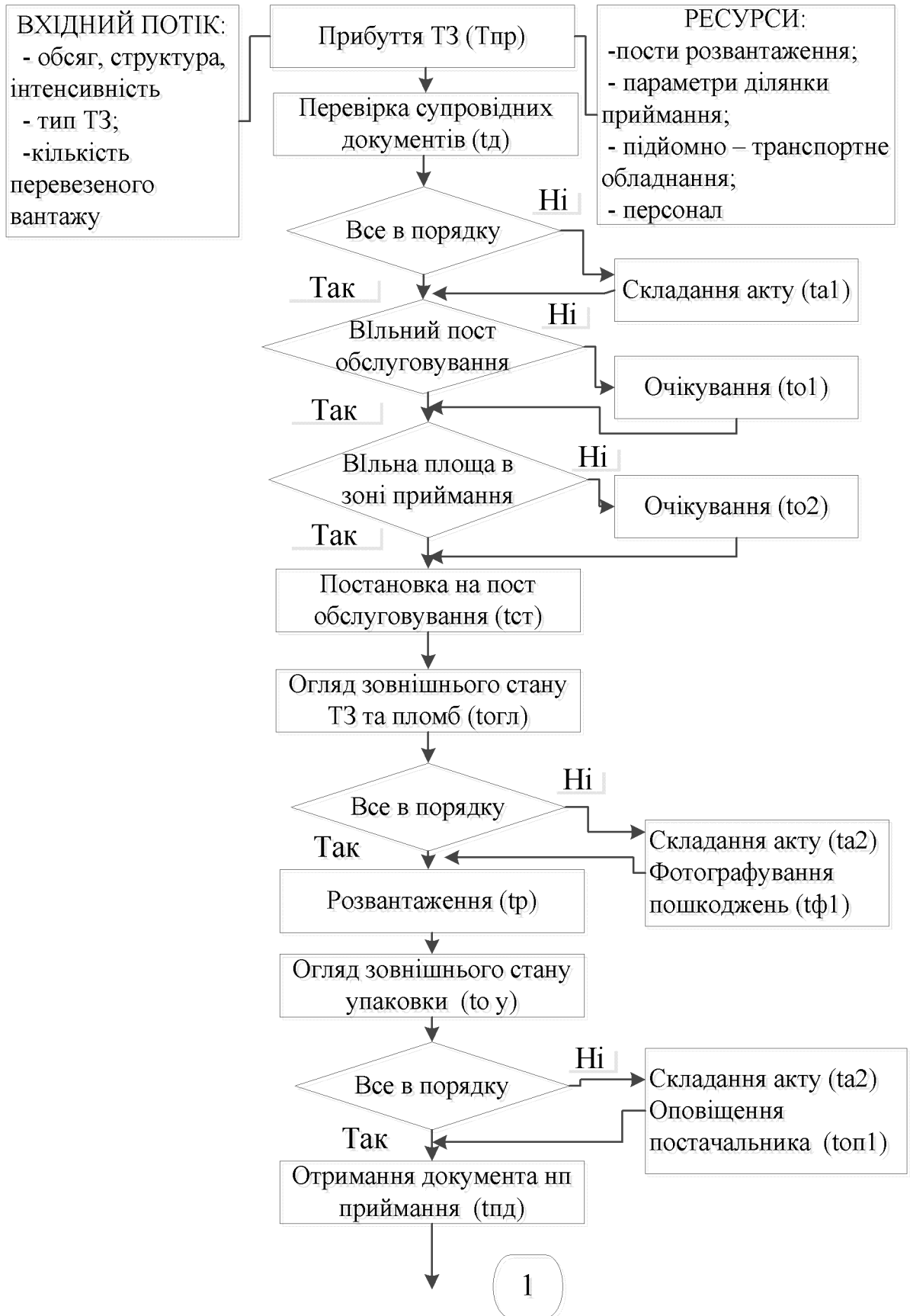
Рисунок 2.2 – Модель обробки вхідного потоку даних в ТСК
