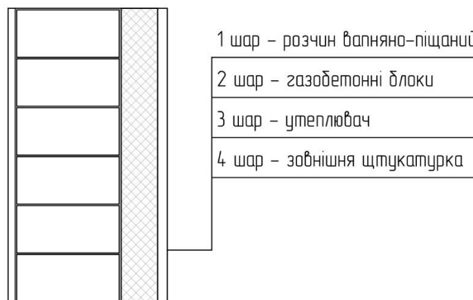
Рисунок 4.1 – Схема для теплотехнічного розрахунку зовнішніх огорожень
