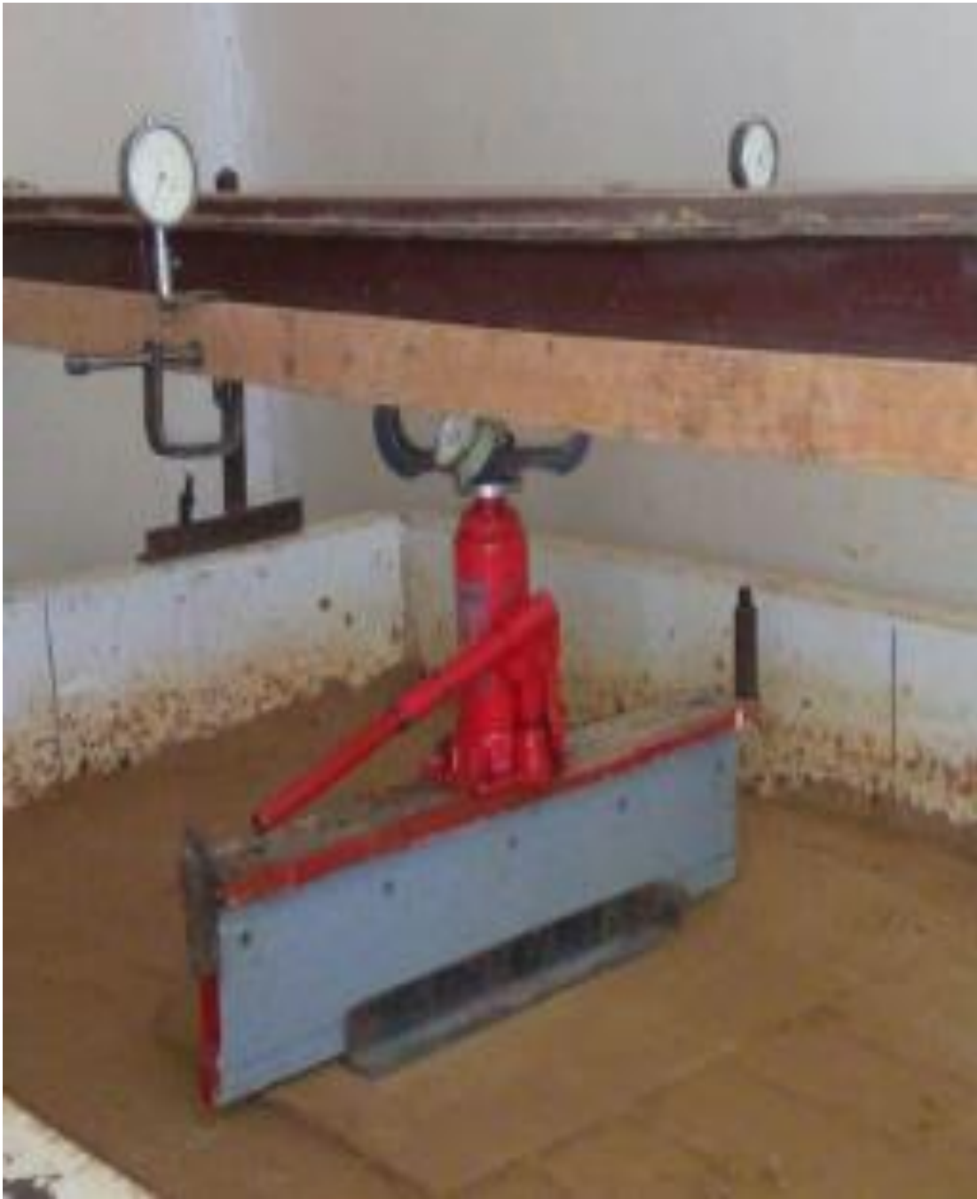
Рисунок 2.4 - Влаштування системи прогиномірів для визначення переміщень/осідань.
