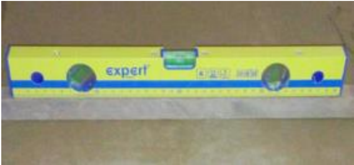
Рисунок 2.2 - Вирівнювання поверхні ґрунту під встановлення моделі стрічкового фундаменту.
