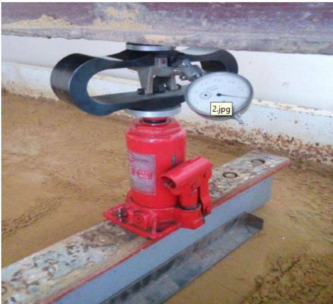
Рисунок 2.3 - Модель фундаменту + система завантаження.
