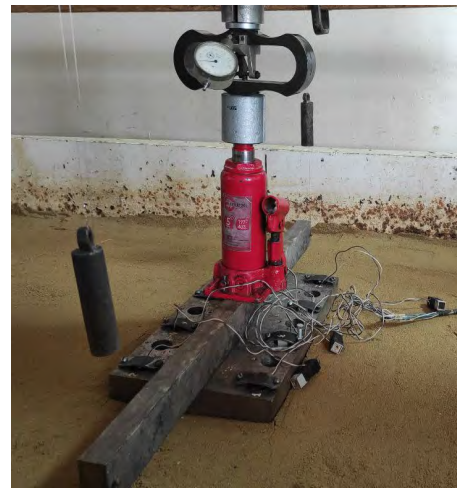
Рисунок 2.9 – Система для досліду випробування а) 14 паль ; б) 8 паль
