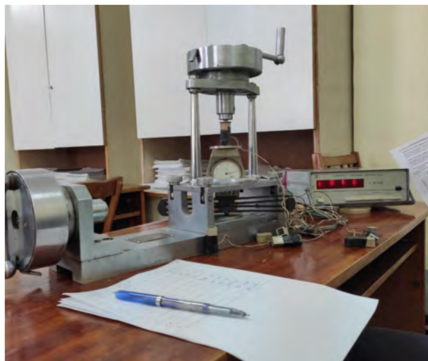
Рисунок 2.3 – Виконання процесу тарування наголовників
