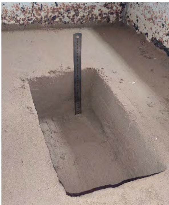
Рисунок 2.11 – Модель випробування плити ростверку у варіанті умовного фундаменту
