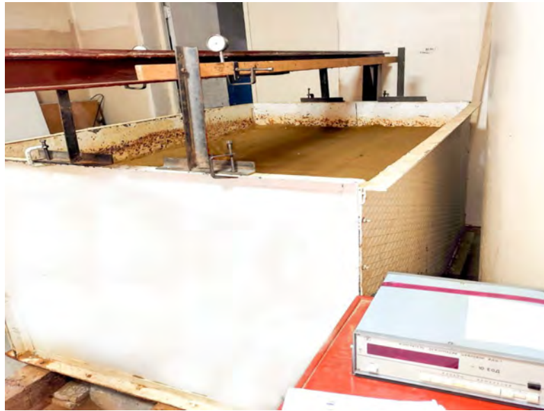
Рисунок 2.1 – Лоток з ущільненим піском, що імітує ґрунтову основу під фундамент
