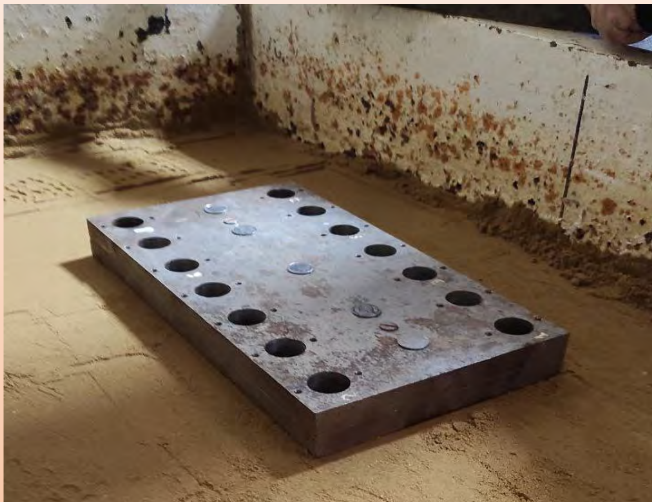
Експериментальна модель фундаменту
