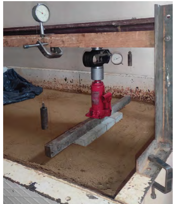
Рисунок 2.11 – Модель випробування плити ростверку у варіанті умовного фундаменту
