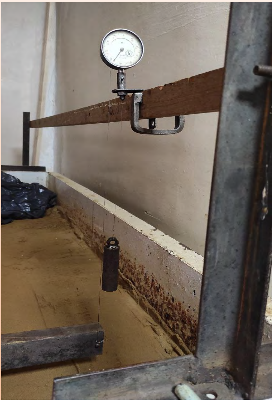
Система встановлення прогиноміру для досліду
