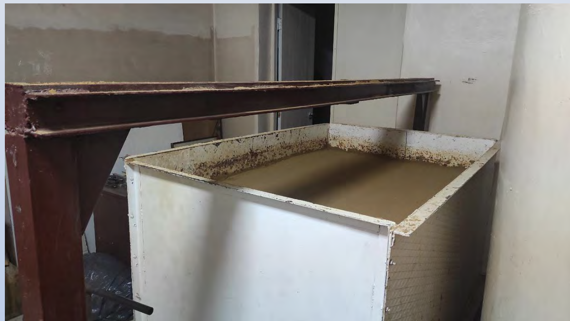
Лоток з ущільненим піском, що імітує грунтову основу під фундамент та упорна система
