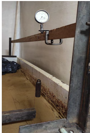
Рисунок 2.6 – Система встановлення прогиноміру для досліду
