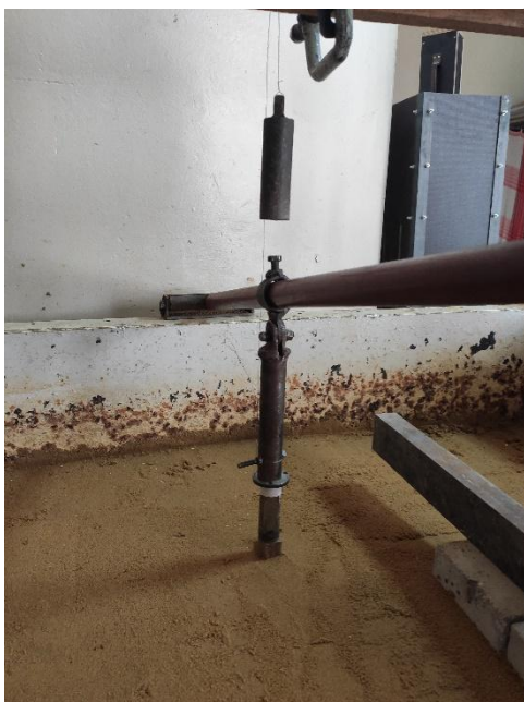
Рисунок 2.10 – Модель випробування одиночної палі в лотку
