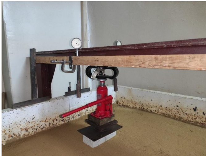
Рисунок 2.9 – Модель випробування плити ростверку у варіанті умовного фундаменту
