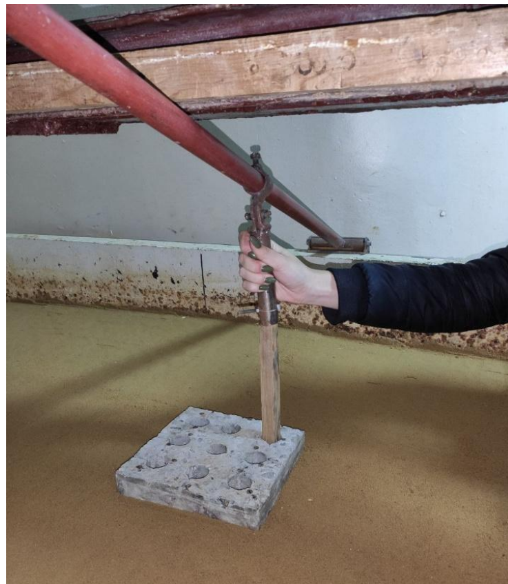
Модель пального фундаменту перед випробуванням
