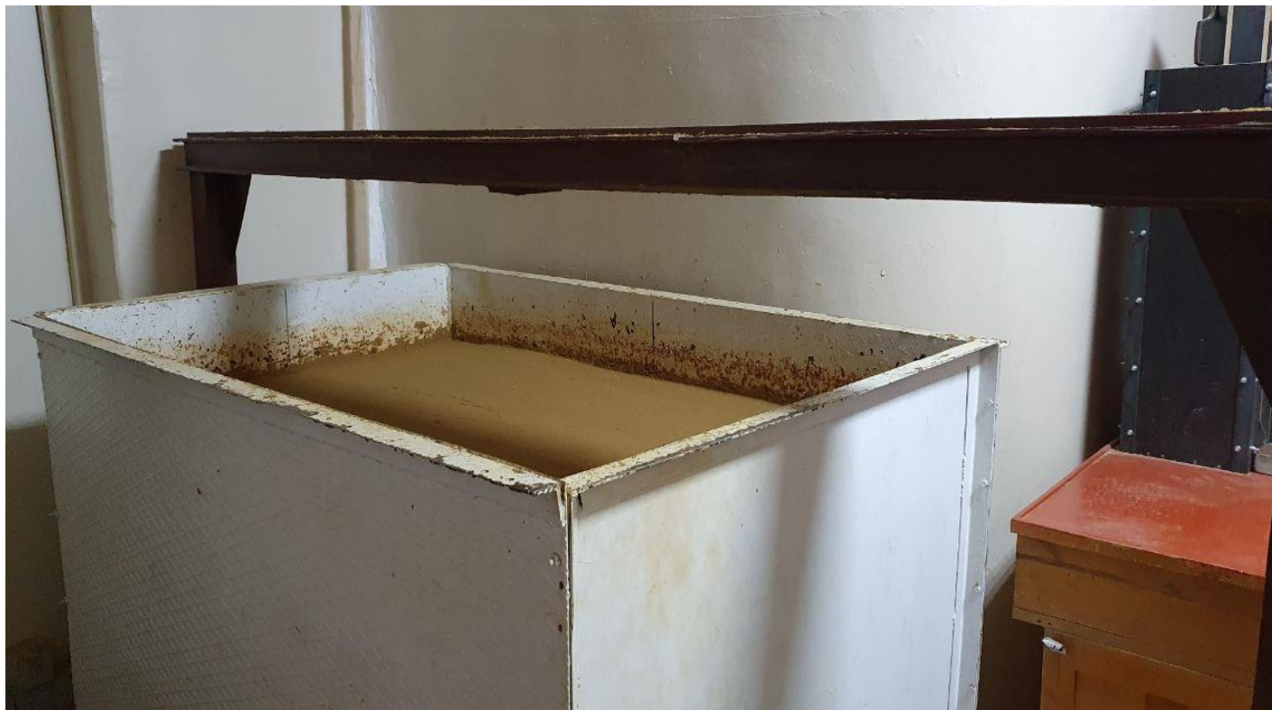
Лоток з ґрунтовою основою розміром 1800×1200×1000 мм
