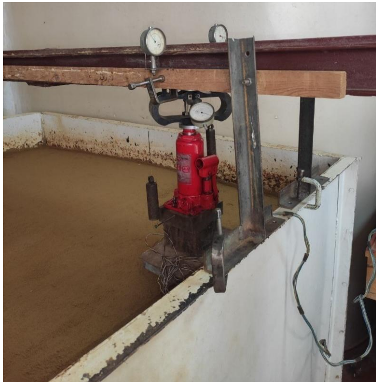
Рисунок 2.7 – Модель пального фундаменту перед випробуванням
