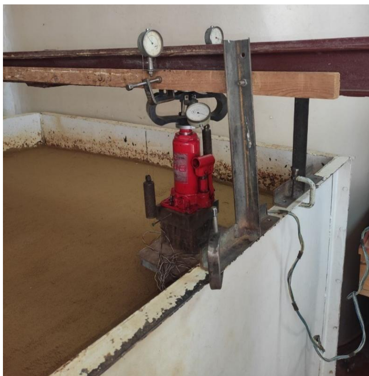
Модель пального фундаменту перед випробуванням
