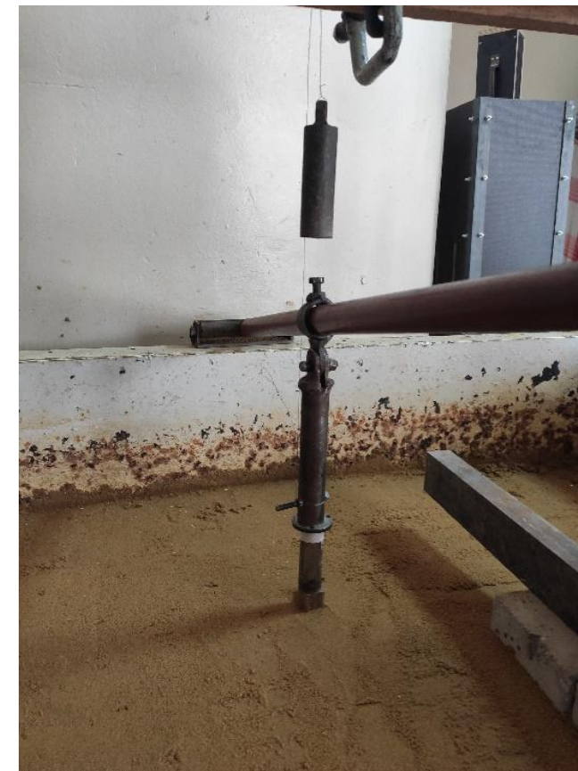
Модель випробування одиночної палі в лотку
