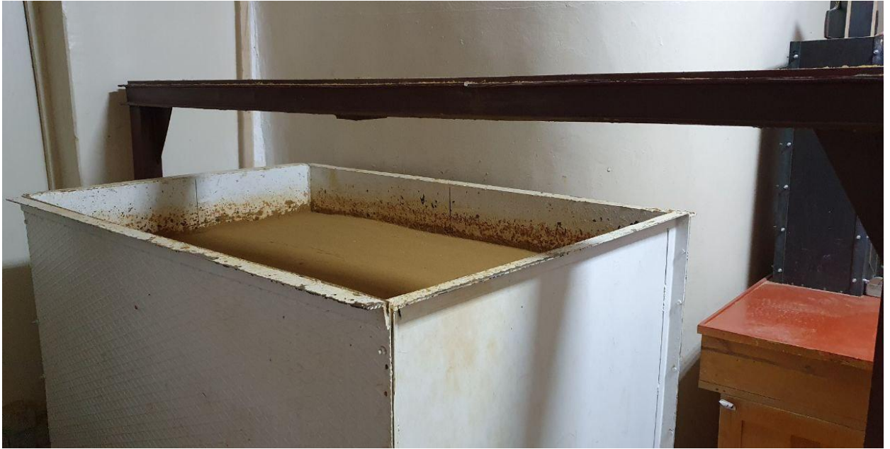
Рисунок 2.2 – Лоток з ґрунтовою основою під фундамент
