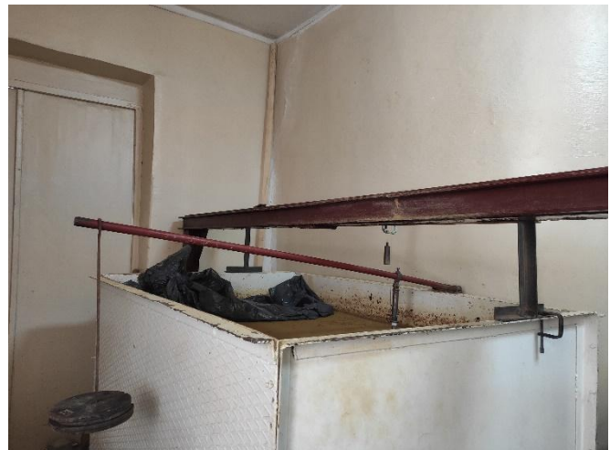
Рисунок 2.10 – Модель випробування одиночної палі в лотку
