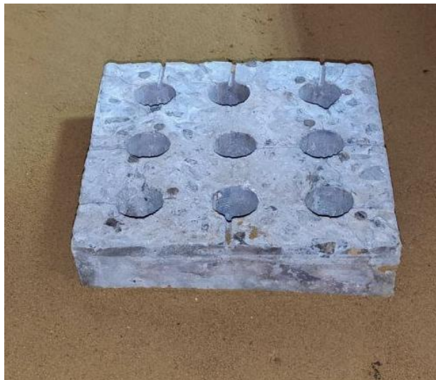
Рисунок 2.1 – Модель ростверку 200×200 мм
