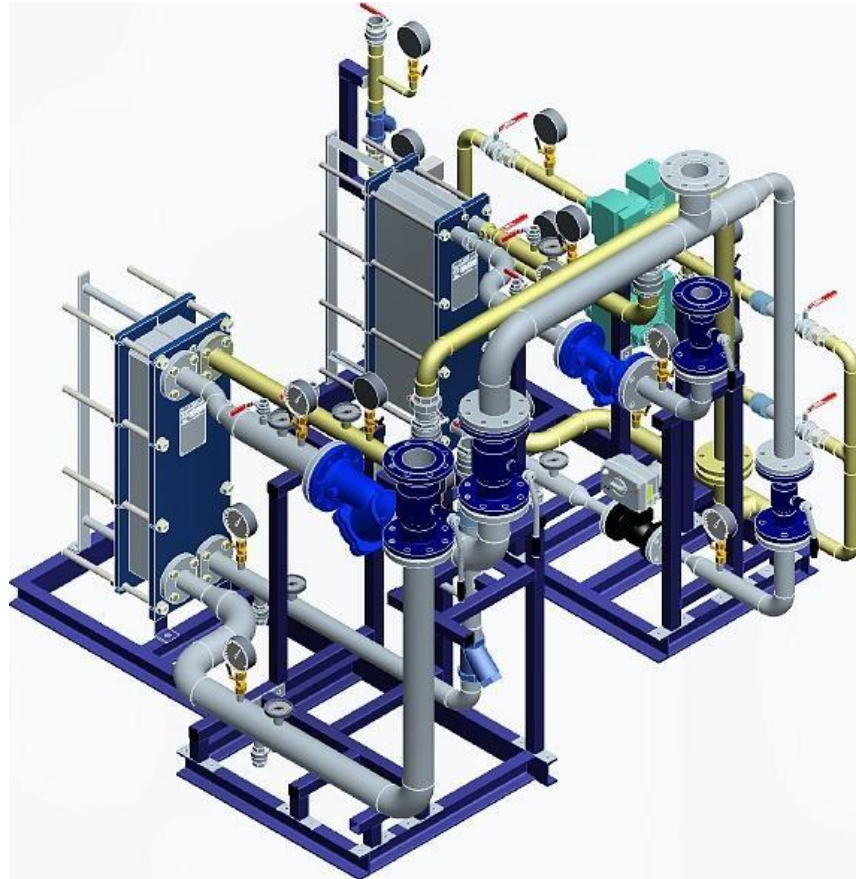
Рисунок 1.6. Сучасний модульний індивідуальний тепловий пункт в зборі
