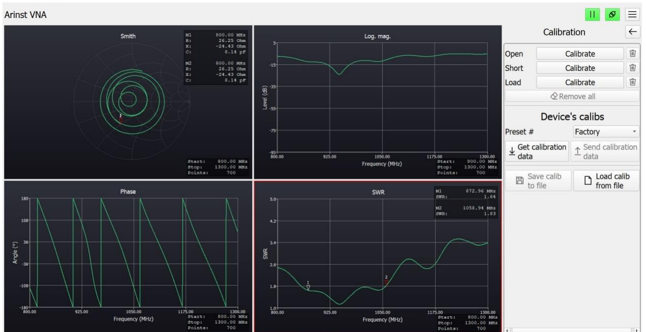
Рисунок 4.5 – Результати експериментальних досліджень антени при заповненні мінеральною водою тefлонового стакану
