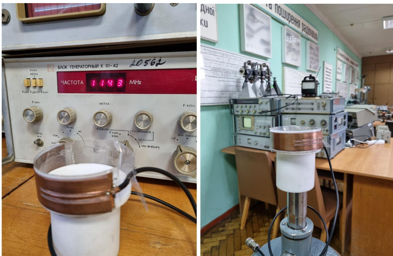
Рисунок 4.2 – Підключення широкосмугової друкованої антени до обладнання для вимірювання КСХ (а) та просторової ДС (б)
