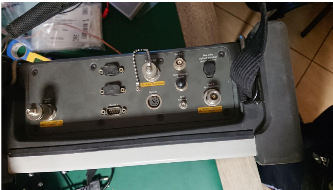
Рисунок 4.2 – Фото цифрового вимірювального приладу Agilent Technologies E7495B 10 Mhz - 2.7GHz Base Station Test Set: фронтальний вигляд (а) і вигляд згори (б)
