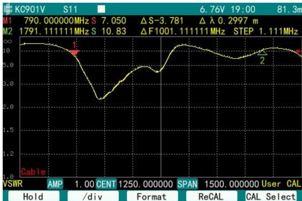
Рисунок 4.5 – Результати експериментальних досліджень КСХ (VSWR) при розташуванні гнучкої антени у повітрі на віддалі
