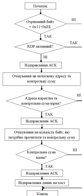
Рисунок 2.22 – Команда Read Memory: сторона мікроконтролера
