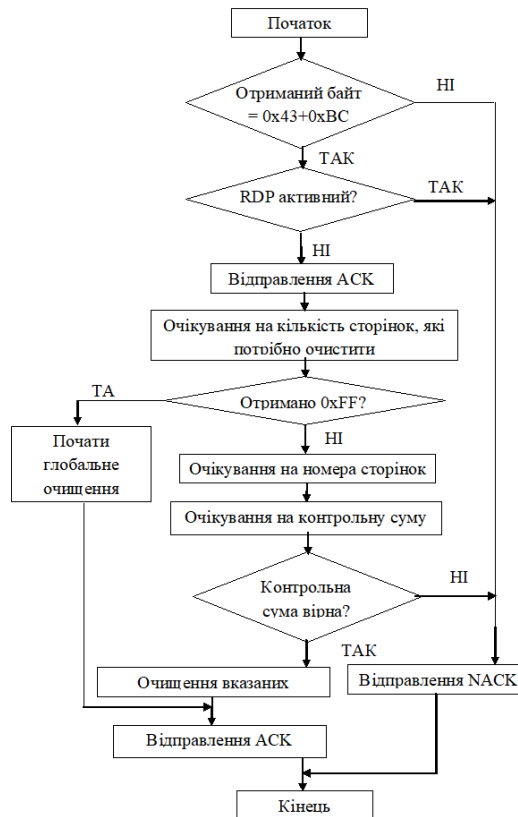
Рисунок 2.27 – Команда Erase Memory: сторона мікроконтролера
