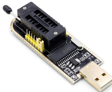
Рисунок 1.2 – Будова автономного комп'ютерного програматора
