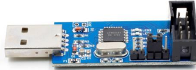
Рисунок 1.3 – Внутрішньо схемний комп'ютерний програматор
