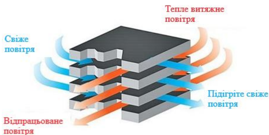
а - пластинчастий рекуперативний теплообмінник
