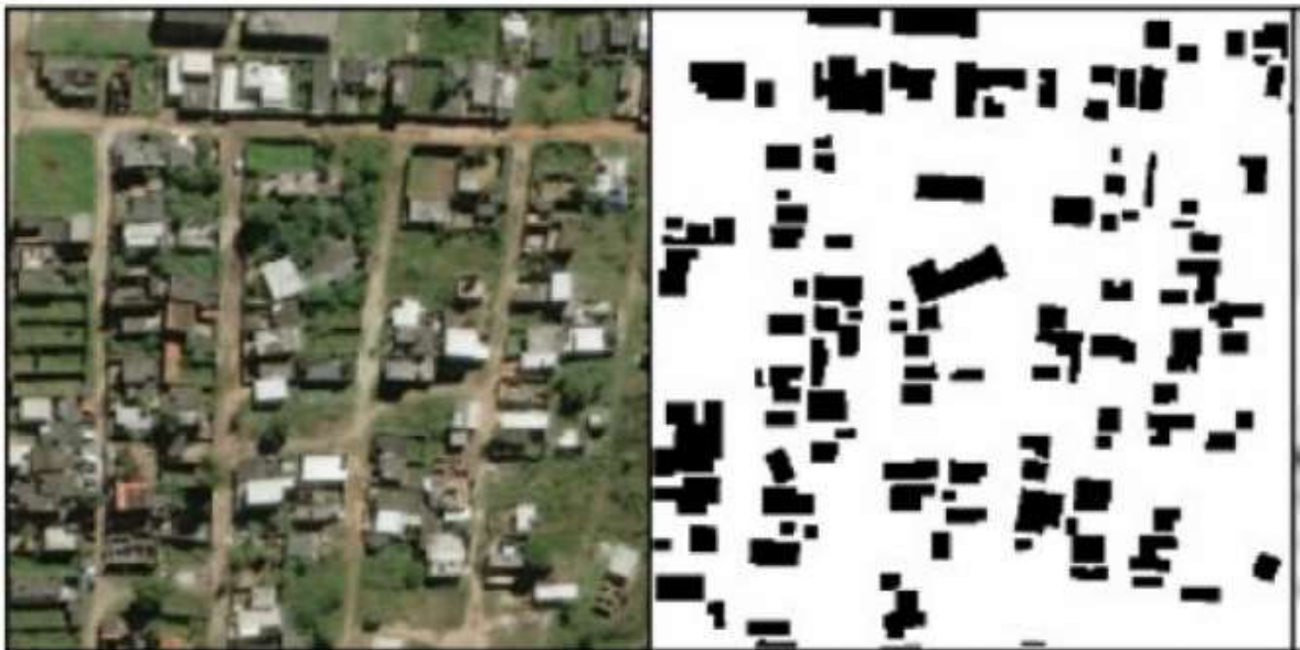
Рисунок 1.11 — Приклад обробки аерофотознімку з використанням SegNet
