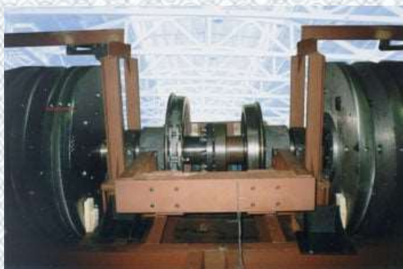
Рисунок 3.5 - Стенд інерційний для випробування гальмівних колодок дискового та барабанного гальм
