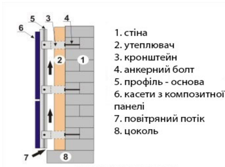
Рисунок 2.1- Конструкція зовнішньої стіни
