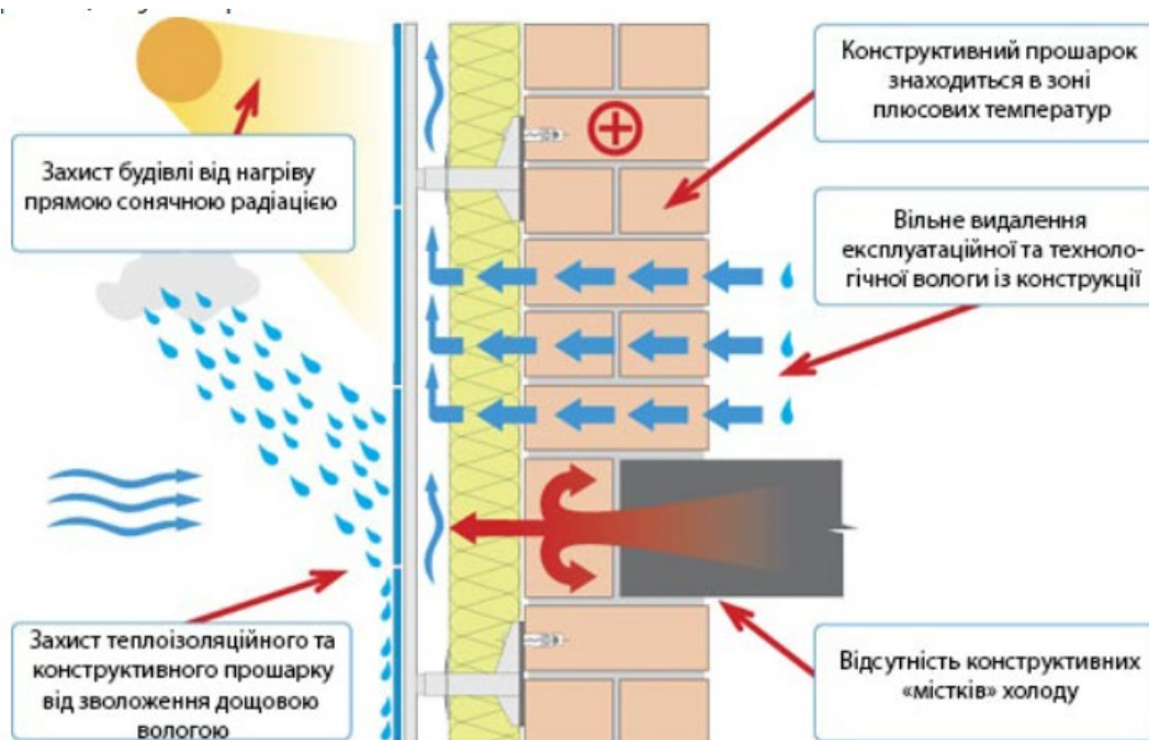
Рисунок 1.5 - Система циркуляції повітря у конструкції вентильованого фасаду
