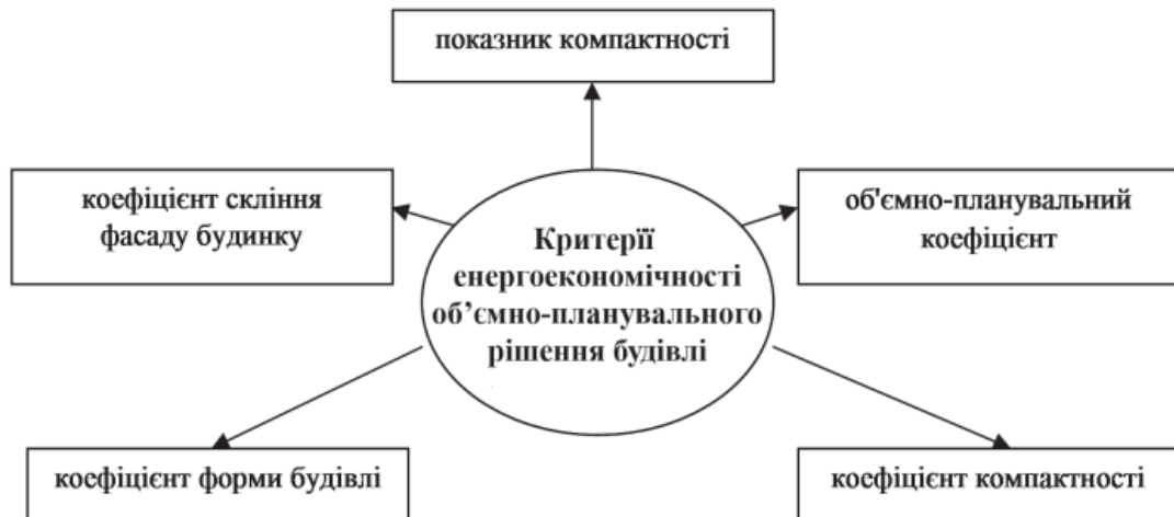
Рисунок 1.2 – Оцінка рівня енерго-економічності об'ємно-планувального рішення будівлі
