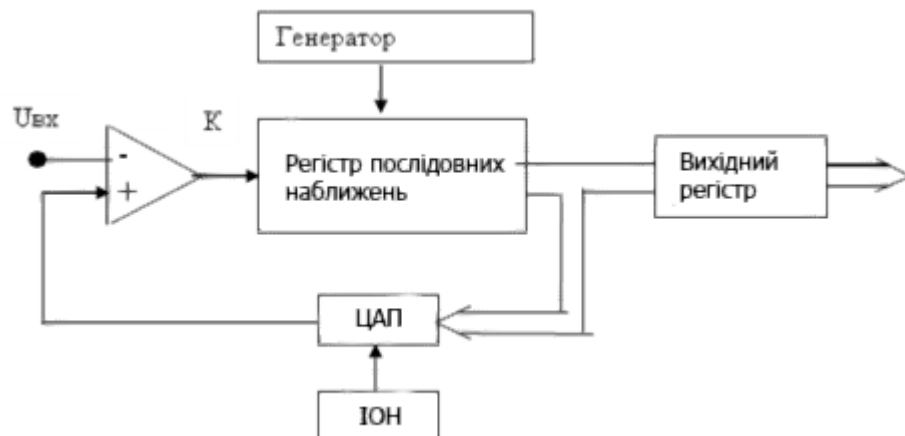
Рисунок 1.8 — АЦП з послідовним наближенням
