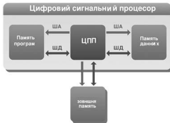
Рисунок 2.1 — Функціональна схема процесорів гарвардської архітектури.
