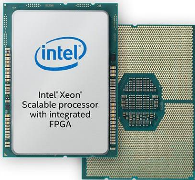
Рисунок 3.3 — Процесор Intel Xeon з інтегрованою ПЛІС
