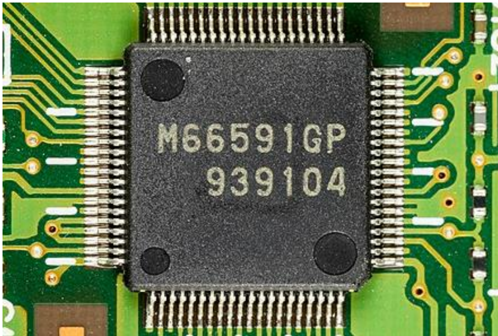
Рисунок 1.1 — ASIC периферійного контролера USB 2.0
