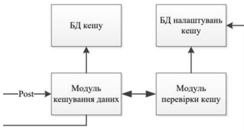
Рисунок 3.20 — Модулі бази даних сервісів для роботи з даними
