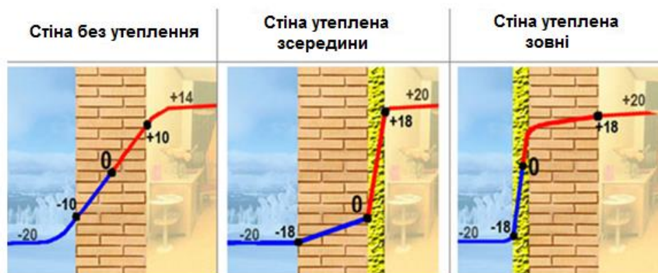
Рис. 1.19 Теплотехнічний розрахунок стіни з різним влаштуванням утеплення
