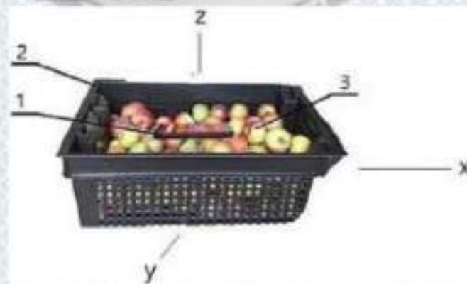
Рисунок 4.8 – Розташування смартфона 1 у ящику 2 з яблуками 3 відносно осей координат x , y , z
