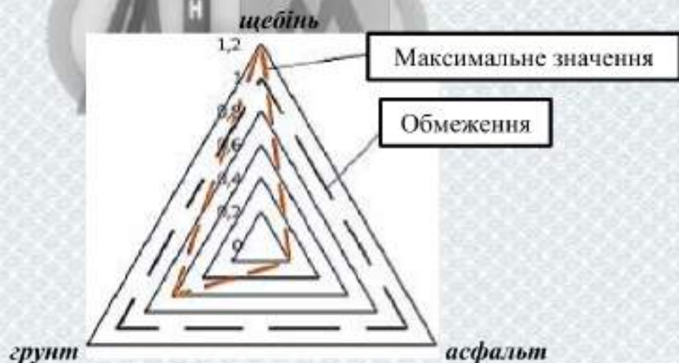
Рисунок 5.10 – Врахування зміни тарифу вантажоперевезення залежно від типу та стану покриття дороги
