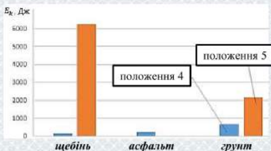
Рисунок 5.18 – Зміна кінетичної енергії окремого плоду вагою 0,143 кг за годину транспортування в залежності від положення ящика в кузові автомобіля при його русі дорогами з різним покриттям зі швидкістю 20 км/год
