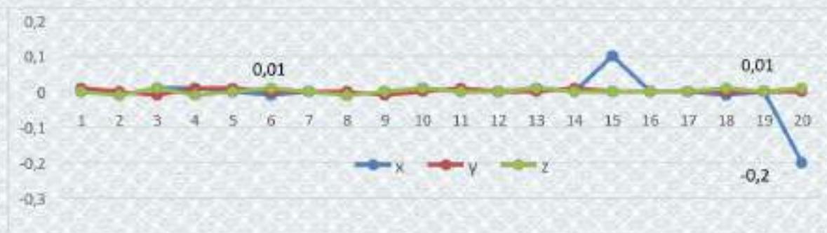
Рисунок 5.8 – Значення прискорень по осях x , y , z для асфальтованої дороги
