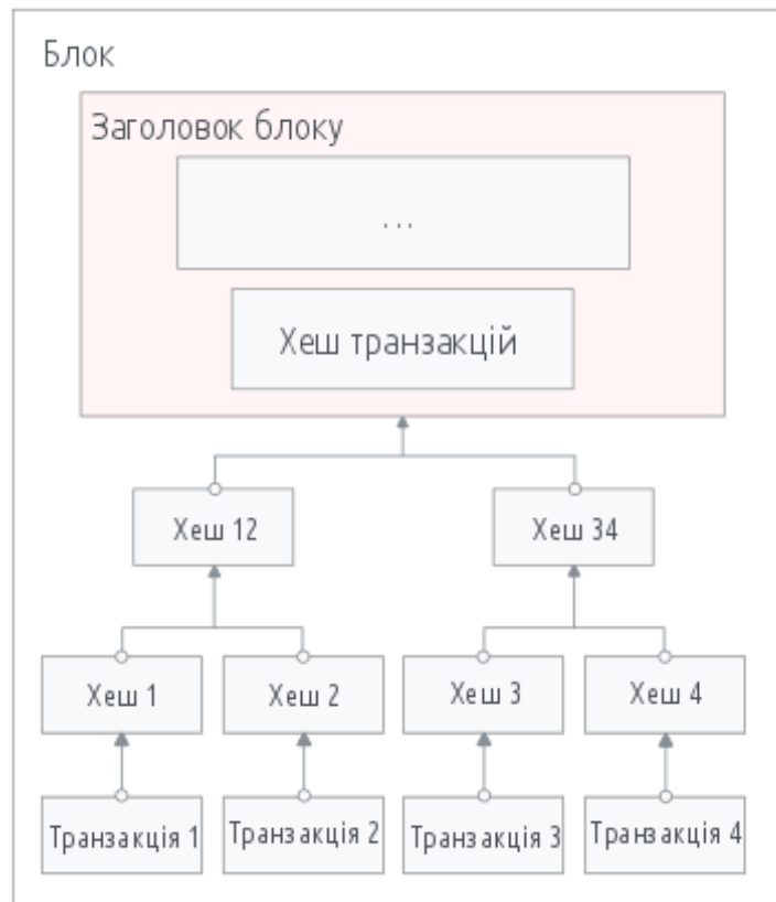
Рисунок Ж.1 — Схема хешів блоків блокчейну
