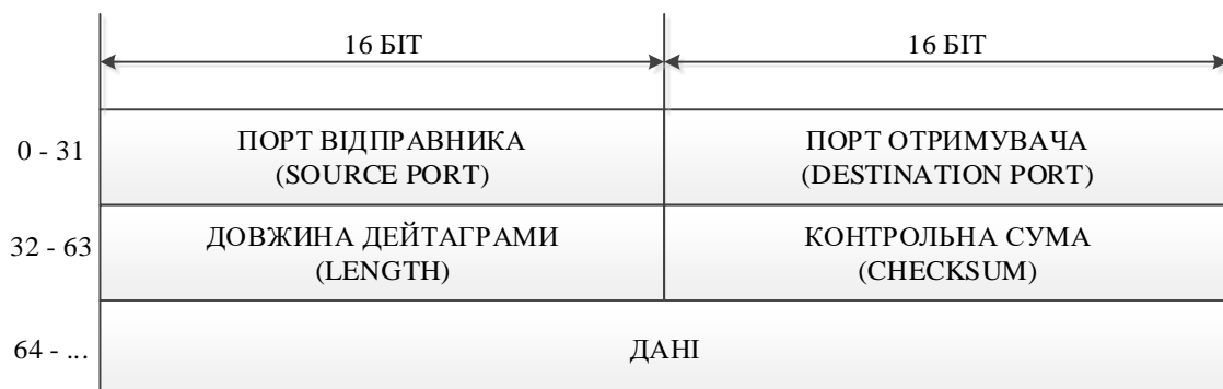
Рисунок 1.1 — Структура заголовку UDP
