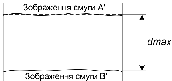
Рисунок 3.8 – Зображення на фотоматриці при максимальній товщині покриття
