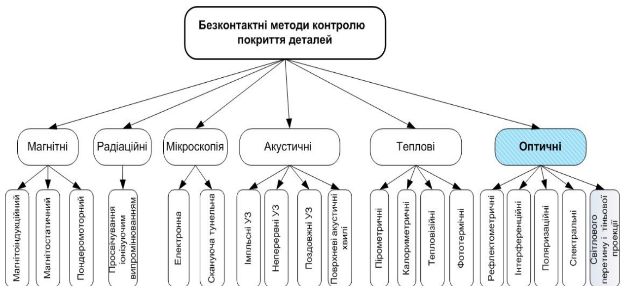
Рисунок 1.1 – Класифікація методів неруйнівного контролю покриття деталей і виробів
