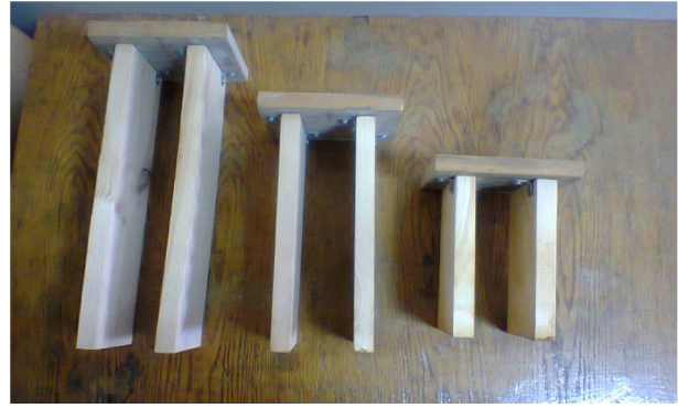
Рисунок 1.17 - Дерев'яні моделі двощільного фундаменту при низькому ростверку з довжиною щілин: а) 400 мм; б) 300 мм; в) 200 мм
