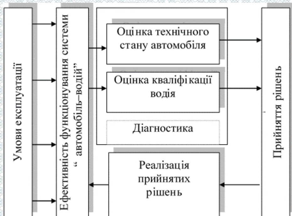
Рисунок 1.3 – Структура управління ефективністю функціонування системи “автомобіль-водій” у напрямі забезпечення безпеки дорожнього руху
