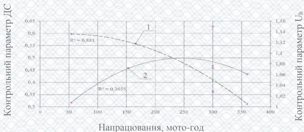
Рисунок 3.5 – Залежність зміни розробленого критерію U_h від напрацювання, а також його взаємозв'язок з контрольним параметром ДС моторної оливи М10–ДМ: 1 – ДС; 2 – U_h
