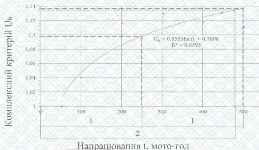
1 – планово-попереджувальній системі ТО; 2 – по фактичному стану Рисунок 3.8 – Ілюстрація періодичності заміни моторної оливи G-Profi SAE 15W-40 API CI-4 в двигунах самоскидів БелАЗ
