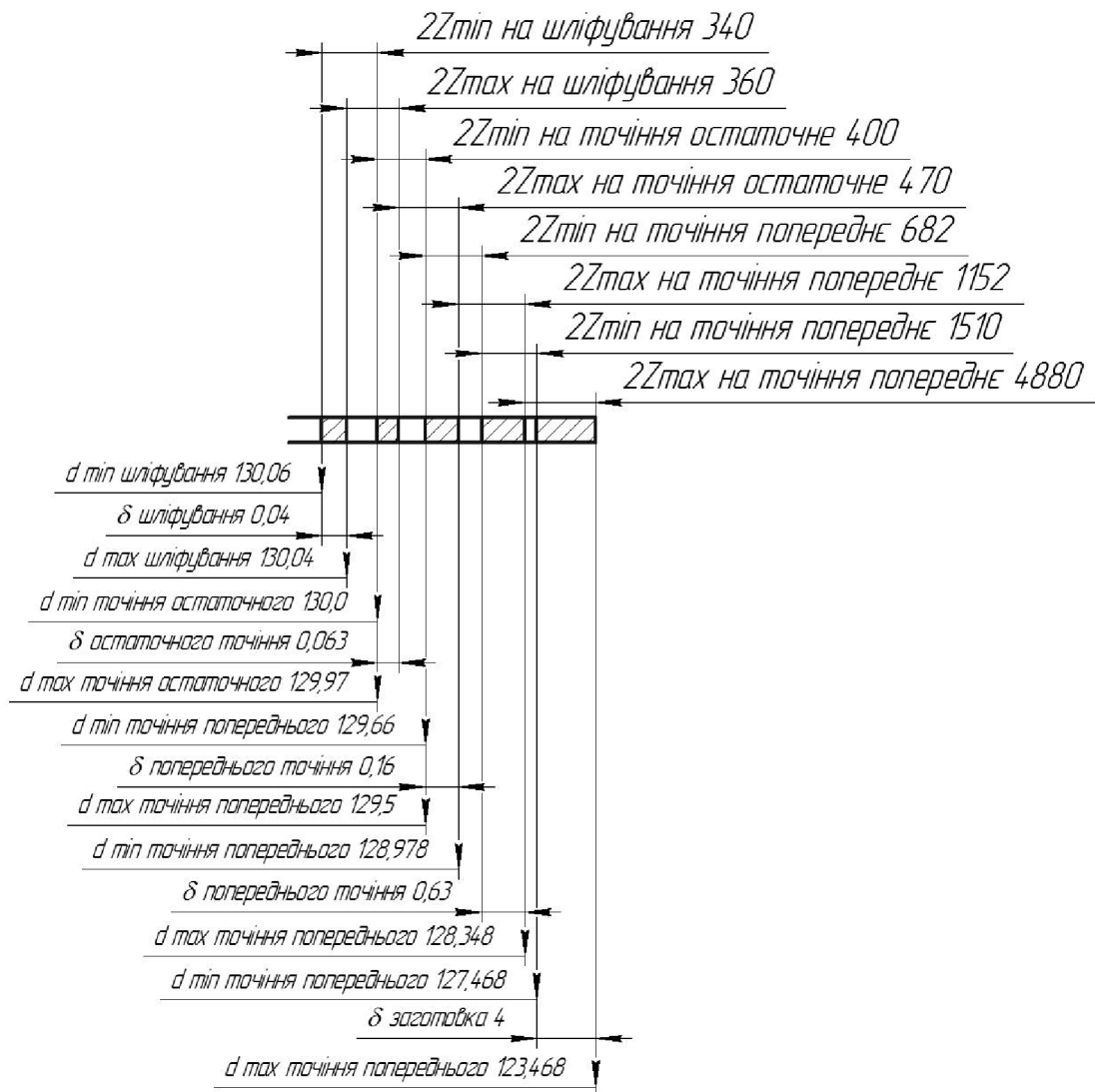
Рисунок 1.10 – Схема графічного розташування припусків і допусків на обробку діаметрального розміру \text{Ø}130\text{H}7
