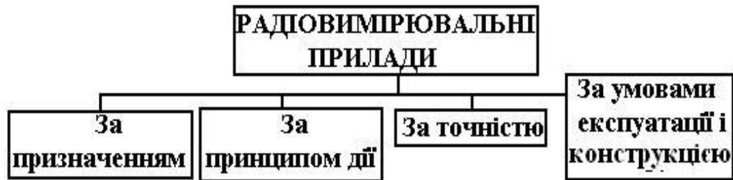
Рисунок 1.1 – Класифікації радіовимірювальних приладів
