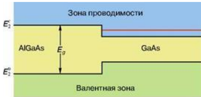
Рисунок 1.2 – Енергетичні зони на межі двох напівпровідників – гетероструктурі. E_2^C і E_2^V – межі зони провідності і валентної зони, E_g – ширина забороненої зони
