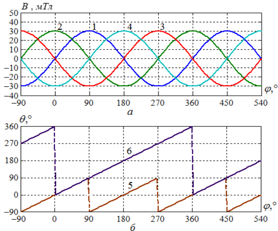
Рисунок 2.6 – Залежність магнітної індукції (а) та вихідного кута (б) від кутового положення контрольованого об'єкта для магнітних систем із чотирма чутливими елементами
