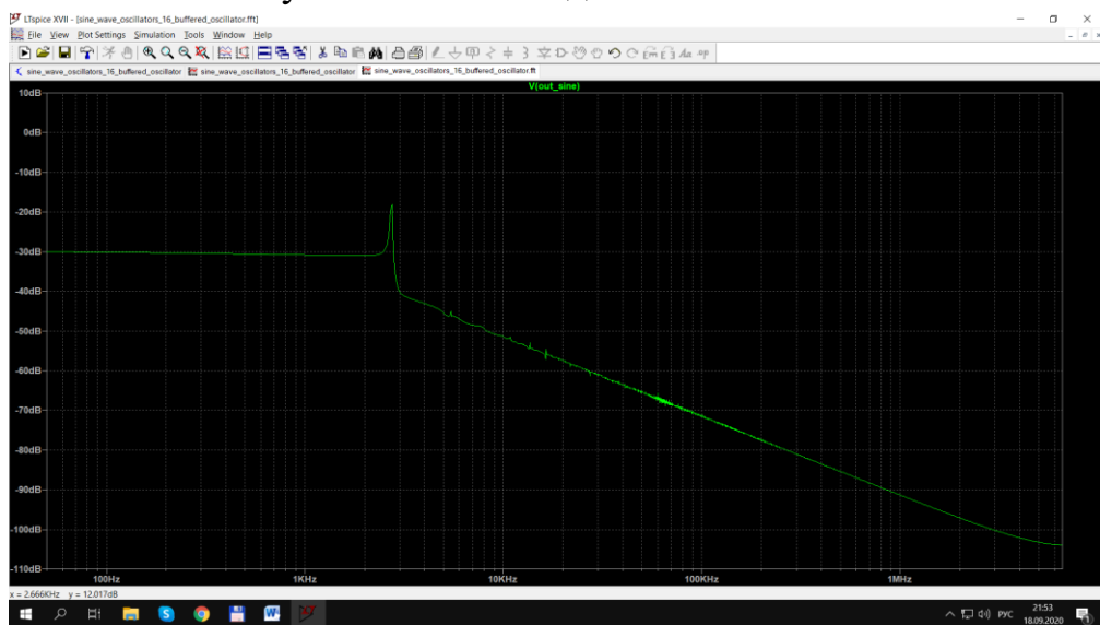
Рисунок 3.25 – Спектральний аналіз буферованого генератора
