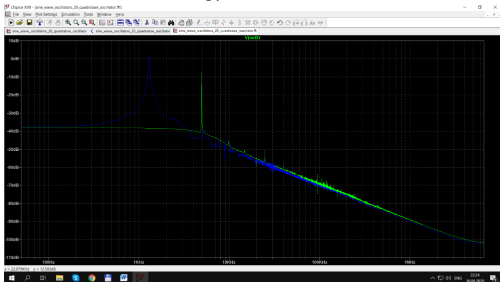
Рисунок 3.34 – Спектральний аналіз квадратурного генератора з підключенням тензорезистора із зміною опору від 15 кОм до 1 кОм
