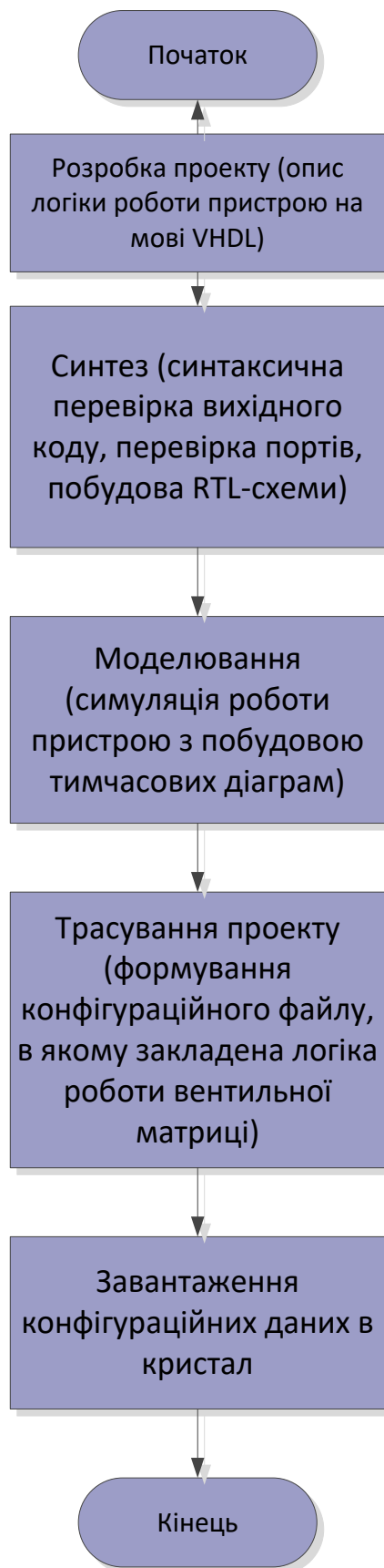
Рисунок В – Етапи проектування пристрою в середовищі розробки WebPack ISE
