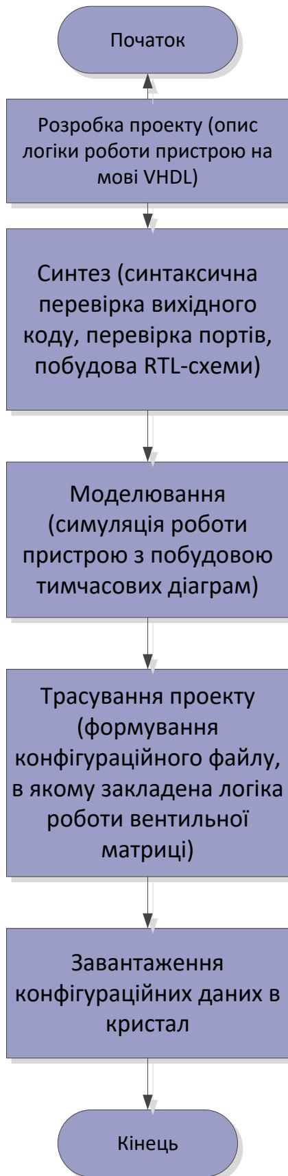
Рисунок 1.2 – Етапи проектування пристрою в середовищі розробки WebPack ISE
