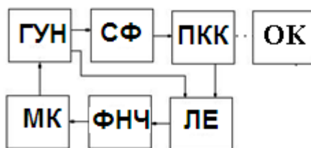
Рисунок 3.16 – Структурна схема вимірювального пристрою (ГУН – генератор; СФ – смуговий фільтр; ПКК – паралельний коливальний контур з активним магнітним ПП; МК – мікроконтролер; ФНЧ – фільтр нижніх частот; ЛЕ – логічний елемент «Виключне АБО»)
