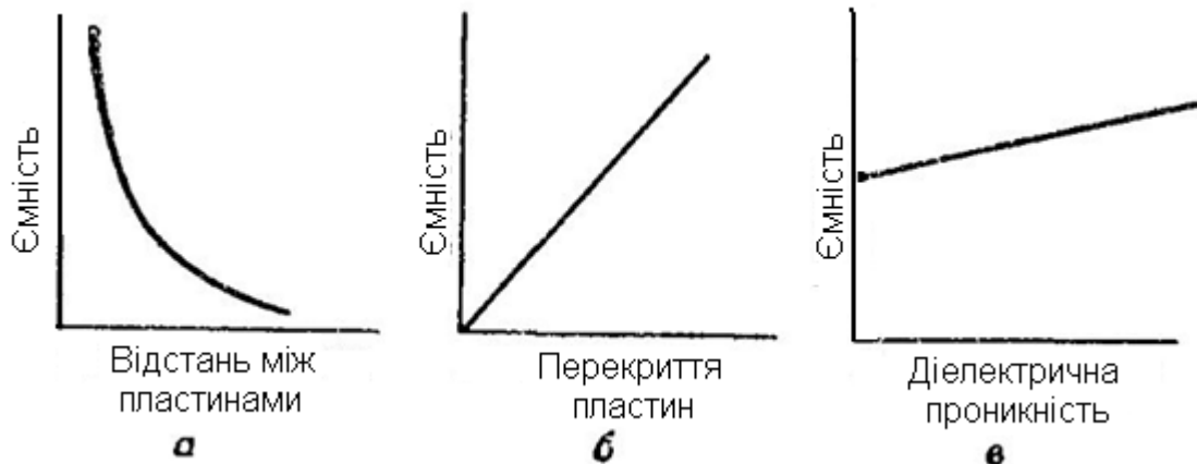
Рисунок 1.7 – Залежність ємності від параметрів первинних перетворювачів (а – функціональна залежність ємності первинного перетворювача від відстані між пластинами конденсатора; б – від площі перекриття; в – від діелектричної проникності зазору між обкладками конденсатора)
