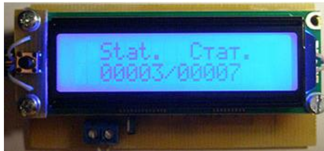
Рисунок 1.3 – Початок роботи кодового замка бездротової ІОТ-система обмеження доступу
