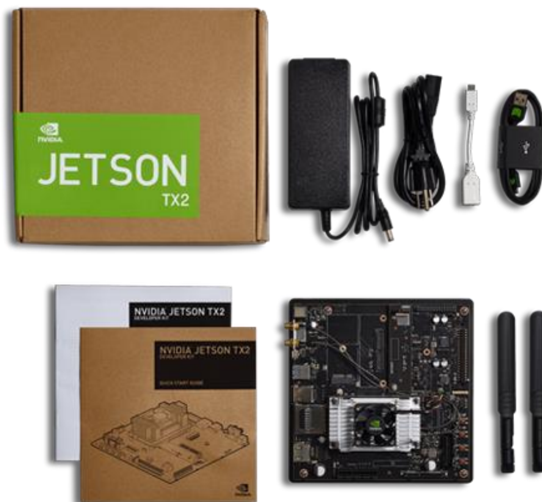
Рисунок 3.5 – Платформа розробника NVIDIA Jetson TX2 Developer Kit в цілому
