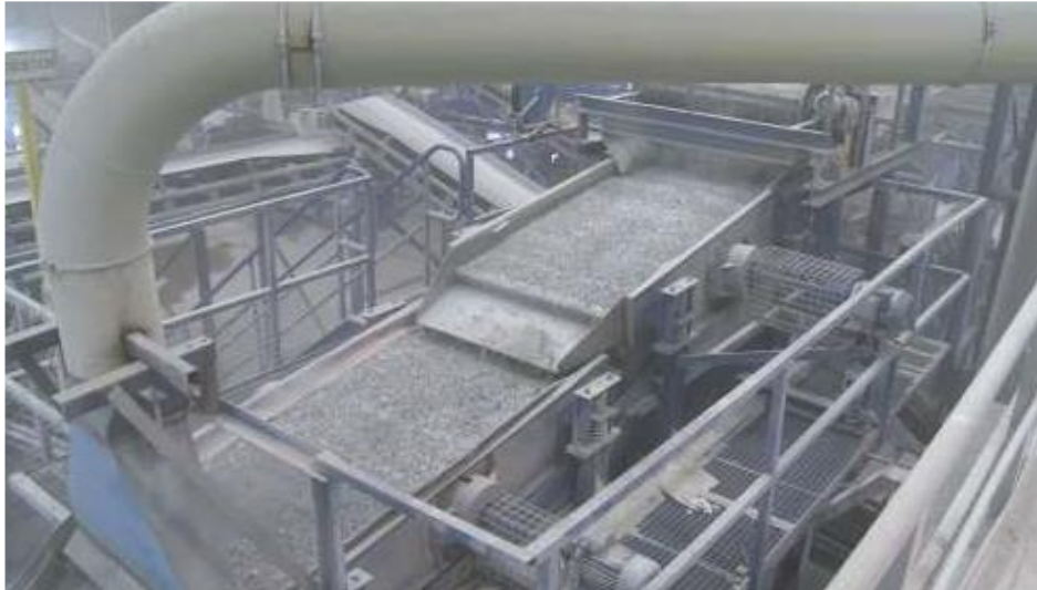
Рисунок 2.1 – Процес подрібнення сонячного модуля
