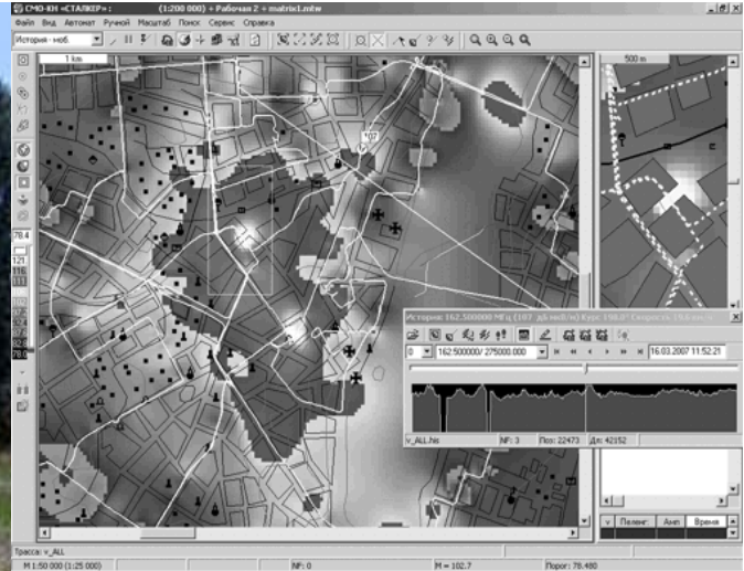
Рисунок 3.5 – Відображення результатів вимірів напруженості поля на карті місцевості
