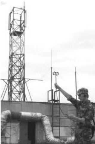
Рисунок 3.6 – Вимірювання інтенсивності ЕМП базової станції GSM- 1800 на даху
