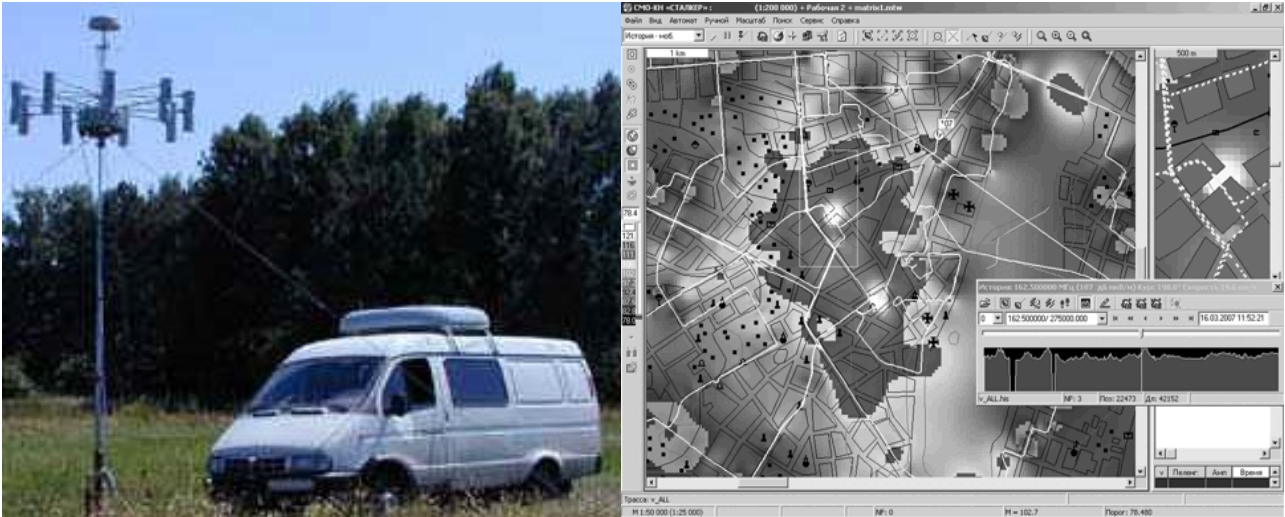
Рисунок 3.5 – Відображення результатів вимірів напруженості поля на карті місцевості
